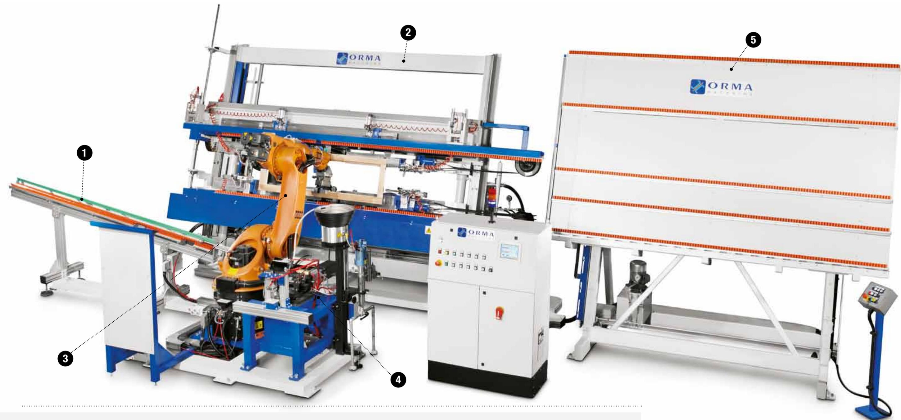
Ecco l'ultimo nato di casa **ORMAMACCHINE**: uno strettoio per serramenti completo, interamente automatico... dalle prime fasi della manipolazione sino allo scarico del pezzo finito, l'isola di lavoro che abbiamo denominato **"FUTURA EVOLUTION"**.
