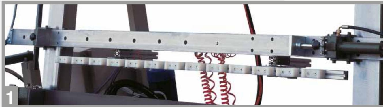
**1** Particolare dell'accessorio denominato "barra orizzontale supplementare completa di pistone e controbattuta" necessario nel caso finestre con traversi centrali.
